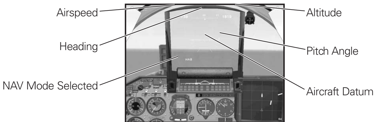
The HAB (NAV) - Piloting HUD
